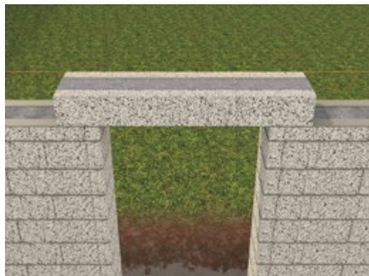
Monter Overligger Exakt over åpninger for å støtte kommende skift.
