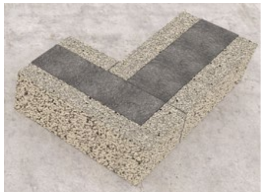
Skjær en blokk på et hjørne for å bryte kuldebroen.
