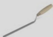
Fugeskje. Brukes til fugging av teglmurer og påføring av fugemasse.
