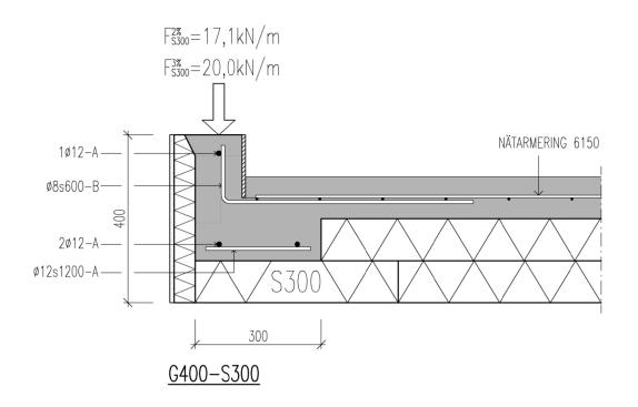
LINJELAST BERÄKNAD MED TILLÅTEN TRYCKPÅKÄNNING MOTSVARANDE 2% OCH 3% DEFORMATION.
